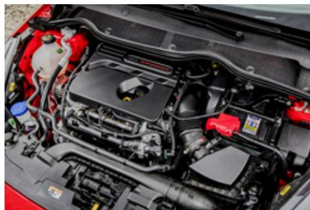
La [Ford Fiesta](#) ST embarque un **moteur trois cylindres** incluant la technologie de désactivation des cylindres.
